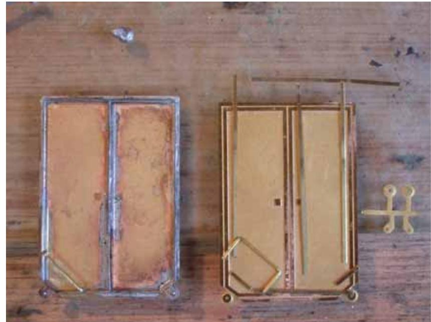
ドアのふちどりに溝があるので、 $0.8 \times 0.2$ 帯板を立てるように付ける。手すりを 0.5真鍮線で作り取り付ける。滑車、滑車押さえを付ける。これらは先に穴を開け 0.5真鍮線を通して付ける。
