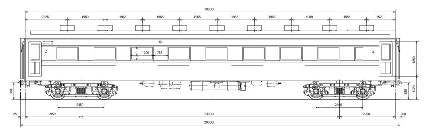
1950年に登場した、従来になかった新しい様式の国電 湘南電車と呼ばれ、それまで電気機関車が牽引していた区間運転の 客車列車に代わって、東海道線に続々と就役 モハ52や42系が長距離用として設計された時代とは、電車運転の 区間を延長したばかりではなく編成輌数も16輌にまでなり、一族 合計650輌、まるで桁が違ってきたわけである 湘南型はモハ80を中心に、クハ86、サロ85、サハ87、モユニ81から 構成されるが、まず1950年第一次型として現れた中からクハ86と サロ85の図を示す 台車はTR43,43A
