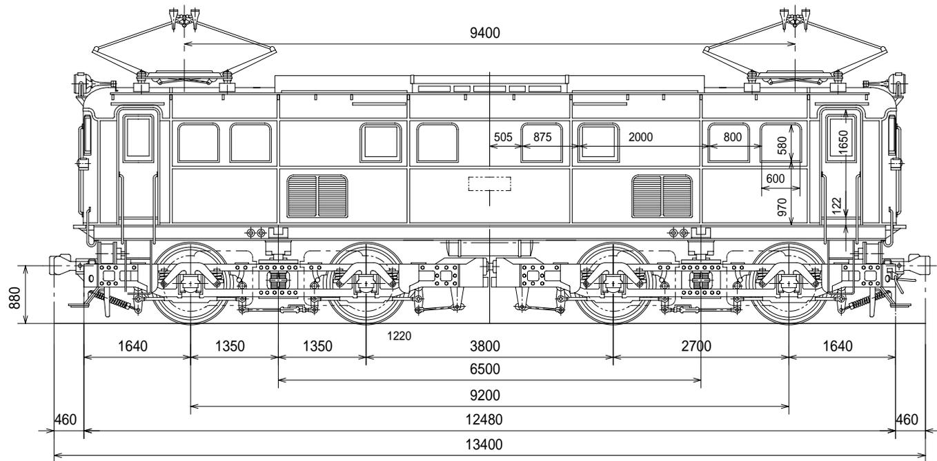
1930年 日本車輛—東洋電機製の私鉄としては大型に属する貨物用電機
