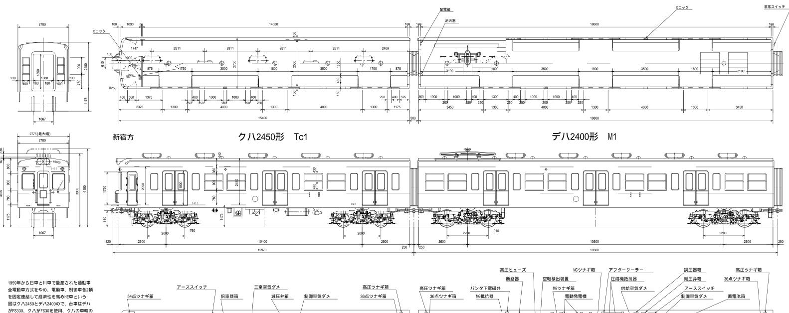
全電動車方式をやめ、電動車、制御車各2輌を固定連結して経済性を高めHE車という図はクハ2450とデハ2400ので、台車はデハがFS330、クハがFS30を使用、クハの車輪の小さいのも特徴のひとつ塗色は2200以来の小田急の標準色たる上半クリーム、下半ブルーの塗りわけ輌数は合計116輌に及び、当時小田急の一の勢力
