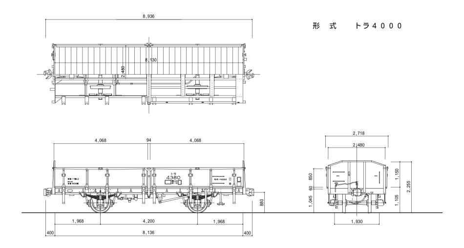
荷 重 ・・・・・・17t 自 重 ・・・8.8~9.0t 床 面 積 ・・・・20.2m² 容 積 ・・・・42.4m³ 走り装置 ・・1段リンク式 車 軸 ・・・・・・12t長 軸 箱 ・・・・・・平軸受 バ ネ ・・・・・・・6種
